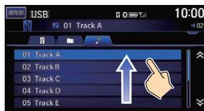
本システムのタッチパネルは厚さ2.5 mm以下の手袋をしたままでも操作できます。ただし、絶縁素材の手袋では操作できません。
