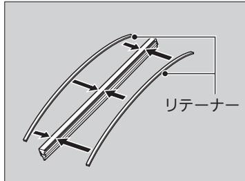
3. 引き抜いたラバーからリテーナーを外し、新しいラバーに取り付ける。
