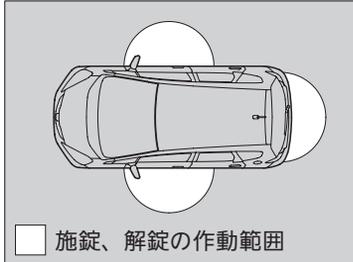
Honda スマートキーを携帯し、ロックボタン、ドアハンドル、テールゲートオープンスイッチを操作することでドア、テールゲート、フューエルリッドの施錠や解錠を操作します。ドア、テールゲート、フューエルリッドの施錠 / 解錠が作動するのは、運転席、助手席ドアハンドル、テールゲートオープンスイッチから周囲約 80cm 以内です。
