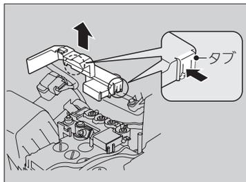
エンジンルーム内の助手席側に付いている、バッテリーの⊕端子の隣にあります。タブ（2カ所）を押してカバーを取り外してください。
