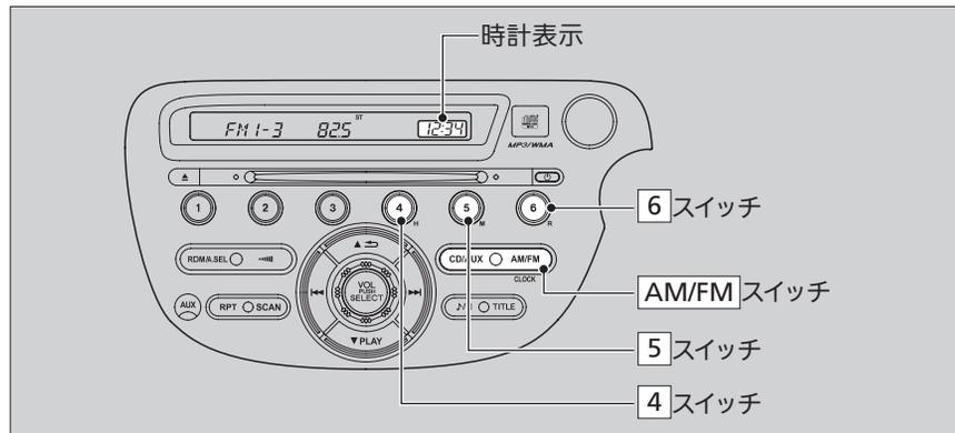
1. **AM/FM** を押し続け、画面の時間表示が点滅したら手を離す。
