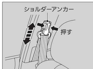
フロントシートのシートベルトは、座高に合わせて、ショルダーアンカーの高さを調節してください。
