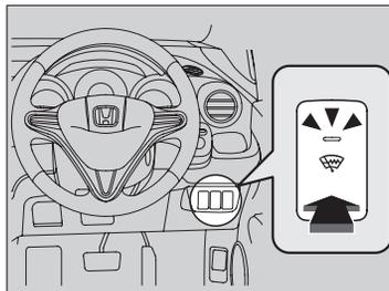
エンジンスイッチがIIのときに、フロントガラスの下端を暖め、雪の固着や凍結によるワイパーブレードラバーの損傷を防ぐことができます。
