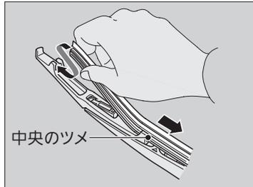
4. ブレード中央部のツメからラバーを挿入し、ブレード両端のツメにラバーを通す。
