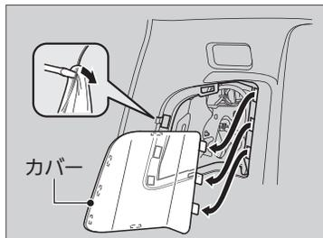
1. カーゴスペース左側にあるカバーに、マイナスドライバーの先端を差し込み、押し開ける。
