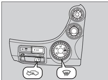
1. ファンスピード切り換えダイヤルを回し、希望の風量に調節する。
