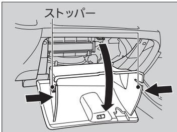
2. グローブボックスの両側に付いているストッパーを内側に押し込み、グローブボックスを下ろす。
