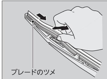
1. ラバーを引いて先端部をブレードのツメから外す。
