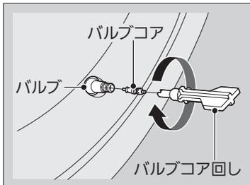
11. バルブコアをバルブに取り付け、バルブコア回しで右に回し、しっかりねじ込む。
