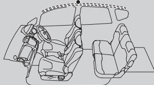
運転席側、助手席側ともに窓側の天井部に格納されています。どちらも「SIDE CURTAIN AIRBAG」と表示されています。
