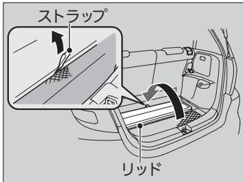
用途に応じて、フレキシブルラゲッジボードの取り付け位置を変えて使用することもできます。
