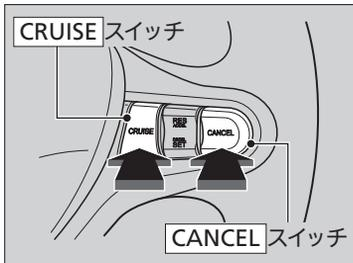
次の操作をすると、自動定速走行が解除されます。同時に、**CRUISE CONTROL**表示灯が消灯します。
