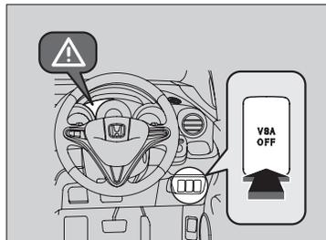
VSA を停止 (OFF) 状態にするには、**VSA OFF** を「ピッ」とブザーが鳴るまで押してください。VSA が停止状態になり VSA 作動表示灯が点灯します。再度使用 (ON) するには、**VSA OFF** を「ピッ」とブザーが鳴るまで押します。
