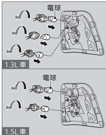
2. ソケットを左に回して外し、古い電球を抜き取る。
