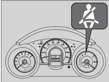
エンジンスイッチを $\square$ にしたときや走行したとき、運転席のシートベルトを着用するまでシートベルトリマインダーが作動し、ブザーと警告灯でお知らせします。
