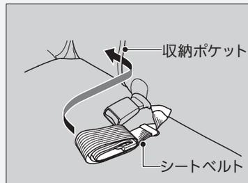
チャイルドシートを取り付けるときは、シートベルトのバックルを図のように動かしてください。
