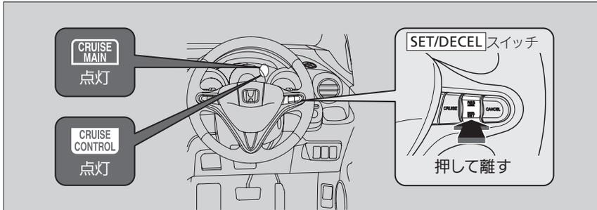
アクセルペダルで希望の車速を出し、**SET/DECEL**を押します。
