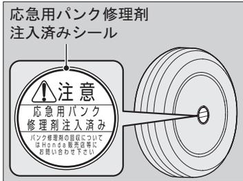
7. 修理が完了したタイヤに、応急用パンク修理剤注入済みシールを貼る。
