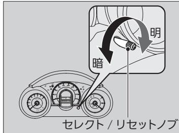
エンジンスイッチがIIで、ライトスイッチがOFF以外のとき（ライトスイッチをAUTO\*にしているときは、車幅灯やヘッドライトが点灯しているとき）、インストルメントパネルの明るさを調節することができます。
