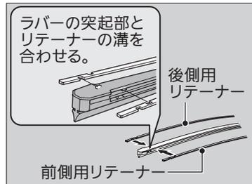
4. ラバーのストッパーがブレードのツメから外れるまで引き、そのままラバーをブレードから引き抜く。
