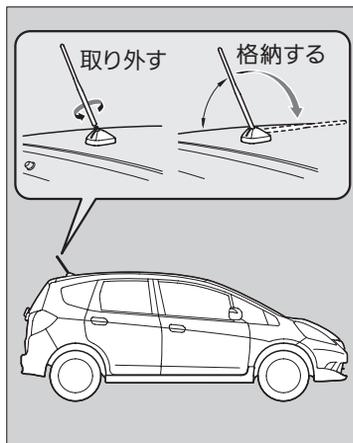
マイクロアンテナは格納、取り外しができます。ラジオを受信するときは、アンテナを節度感のあるところまで立ててください。
