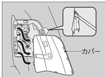
1. カバーの切り欠き部にマイナスドライバーの先端を差し込み、カバーを取り外す。
