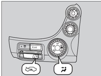
空気取り入れ口から外気を取り込み、車内の空気を循環させて後部のサイドパネル付近の排出口から排出し、換気します。
