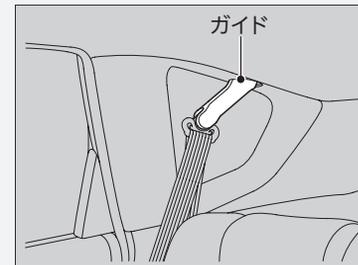
リヤシートのシートベルトのバックルをループ（ゴムバンド）から外さないでください。シートアレンジなどのときにバックルがシートクッションの下に落ちることがあります。
