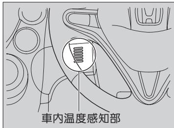
オートエアコンには、センサー（日射感知部、車内温度感知部）が付いています。センサーの上にものを置いたり、水をかけたりしないでください。
