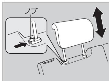
乗車するとき、走行する前にヘッドレストを引き上げて、確実に固定します。
