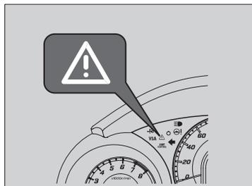
TCS 機能または横滑り抑制機能作動中は、VSA 作動表示灯が点滅します。
