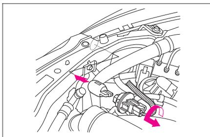
ウォッシャー液タンクを固定するときは、クリップを中央部のピンを起こしたままウォッシャー液タンクに差し込み、ピンを平らになるまで押し込みます。
