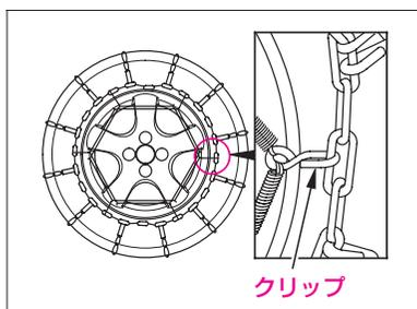
⑦試走してチェーンのゆるみ、はずれなどがなければ確認します。
