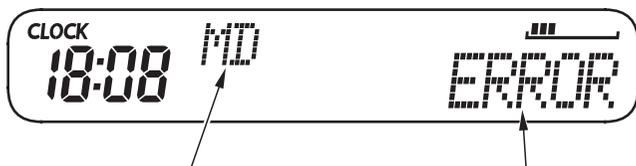
エラーが発生しているプレーヤーを表します。 エラーコードの種類を表します。
