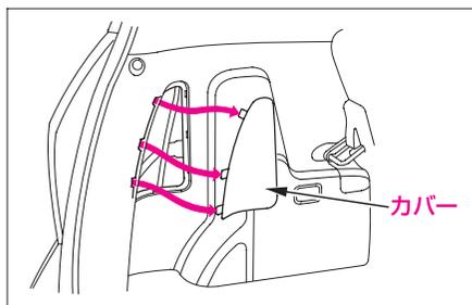
②ボルトをゆるめて、アクチュエーター本体を後方へずらします。
