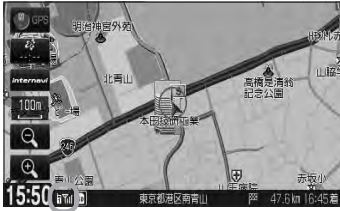
アンテナ3本：電波状態良好
