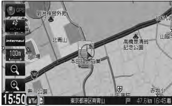
アンテナ3本：電波状態良好
