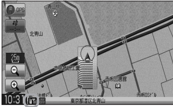
アンテナ3本：電波状態良好
