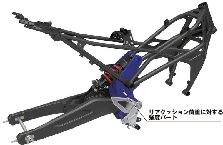
同時に、ねじれ剛性の基部となるメインパイプをヘッドパイプ下端に接合した構成とすることで、ねじれ中心を下げました。これにより、軽量化に伴うコーナリング時などのねじれ増大が生む前輪接地点変化を抑え、安定感のあるハンドリングを実現しました。また、メインパイプとダウンチューブを繋ぐ部材に薄板プレス鋼板を採用し、車体ピッチングを抑制する縦剛性を確保しました。
