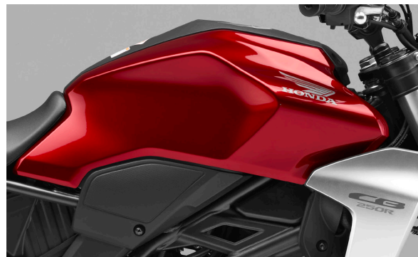
■タンクシェルター
