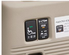
■主電源スイッチ
