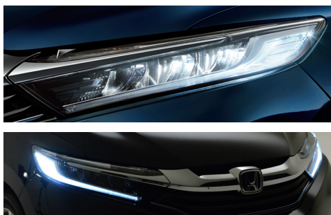
LED光源からリフレクターで反射させ前方に照射
