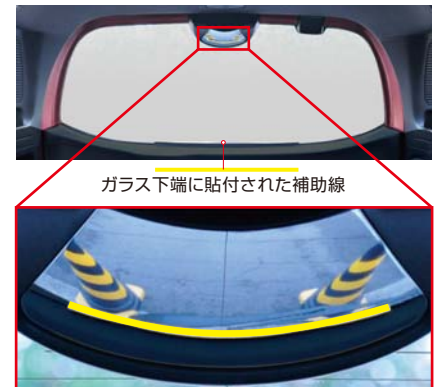
補助線がミラーに映り、自車のおよその車幅および後端の目安となる
