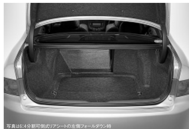
写真は6:4分割可倒式リアシートの左側フォールダウン時
