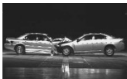
テスト車両によるクルマ相互の衝突実験 右アコード
