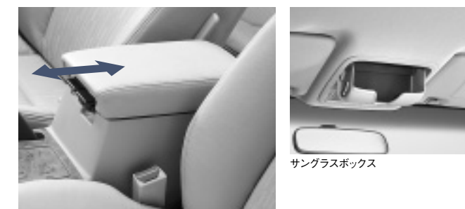
フロント・スライドアームレスト付コンソールボックス
