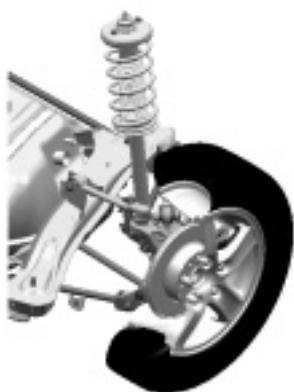
5リンク・ダブルウイッシュボーン・リアサスペンション
