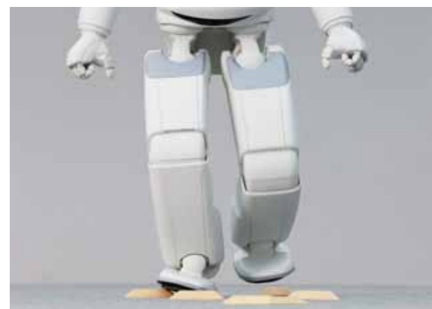
凹凸のある路面を踏破するASIMO
