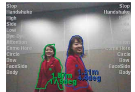
移動体抽出:複数の移動体までの距離、方向を認識
