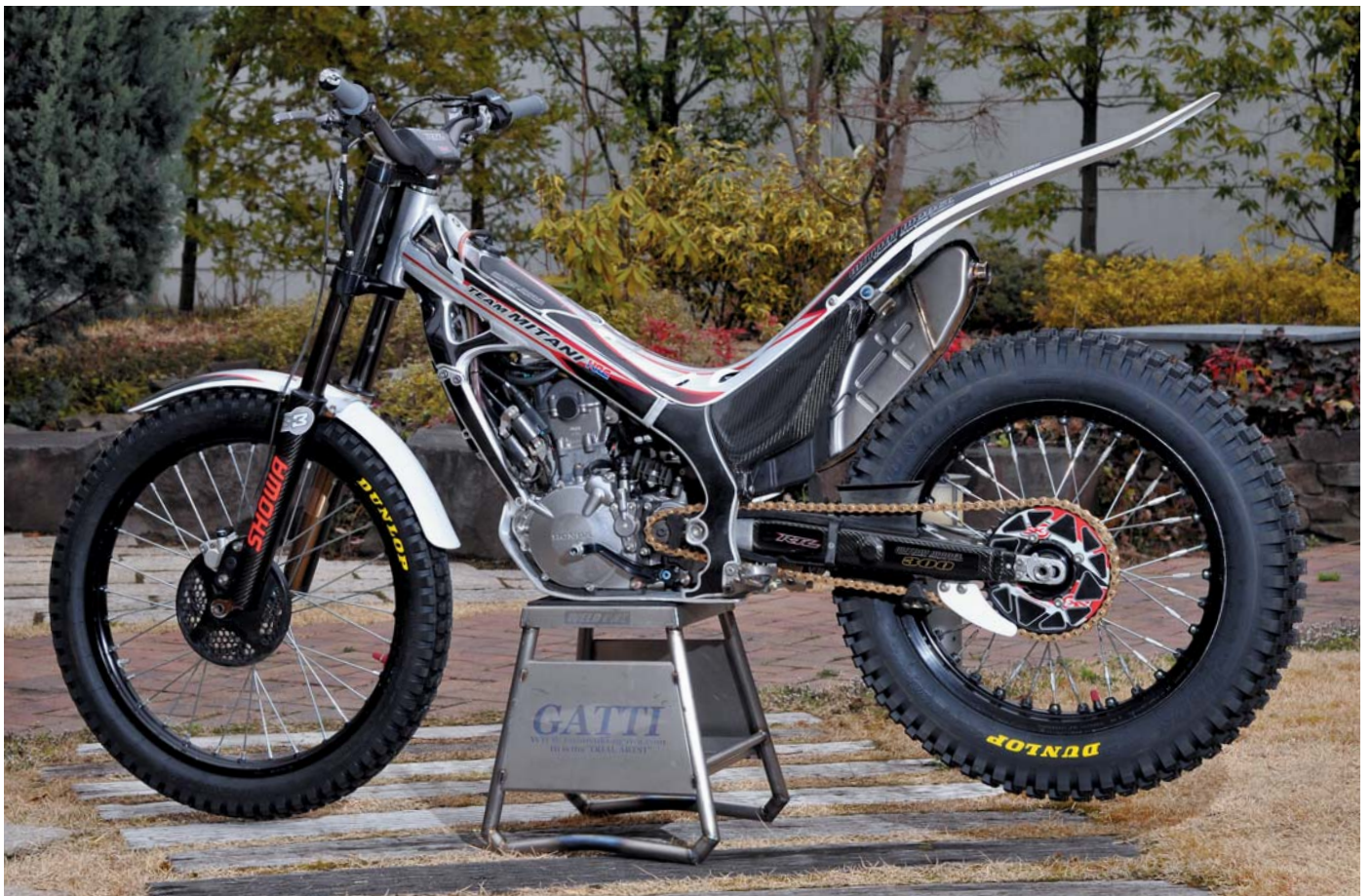
■あとのページで説明するが、トライアルマシンが一般のオートバイと最も異なるのはシートがないことである。ライダーが体を前後左右に大きく動かすトライアル競技に、シートは邪魔なのだ。
