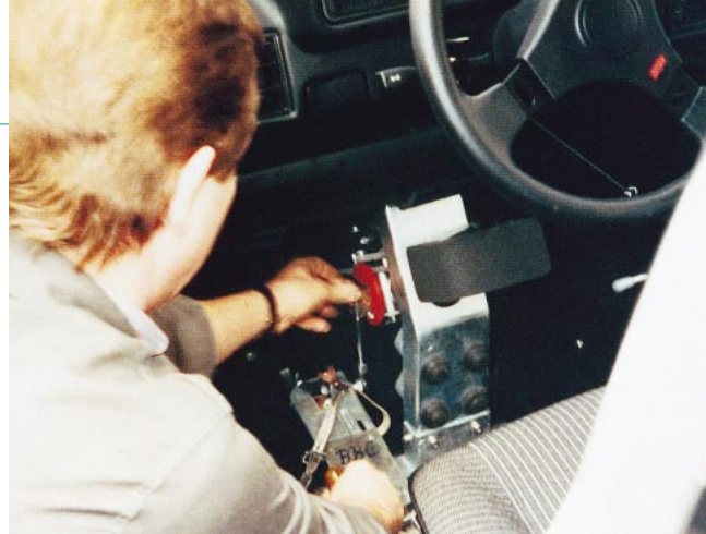
BBC社マンハイム工場で、フランツ・システム車のステアリングベダル部分の調整をする技術者
