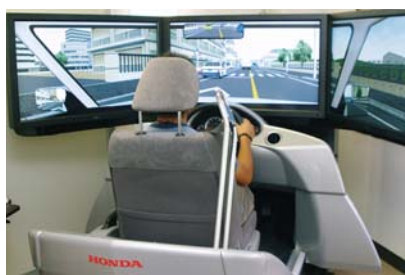
メインモニターには高画質42型HD液晶ディスプレイを採用。広い視野角と迫力のある画面で、左右確認も容易にできる
