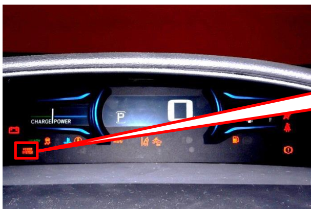
パワーシステム警告灯
